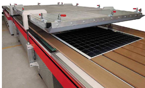
Συναρμολόγηση φωτοβολταϊκών πλαισίων (Στάδιο 3)
